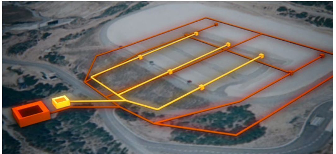
Esquema de los drenajes de aguas subterráneas.
